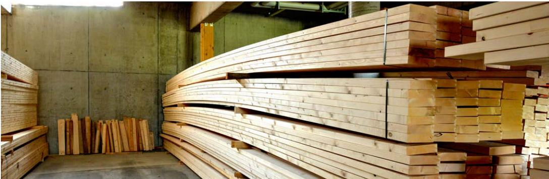
Ausgangsprodukt in unserer Produktionslinie sind Holzbretter geschnitten im Rift- oder Halbribrtschnitt. Diese werden von uns beginnend von der Keilzinkung, über die Verdübelung zum DD-Element, weiter zur CNC-Abbundanlage sowie Handabbund, bis hin zur Montage durch unser eingespieltes Team verarbeitet.
